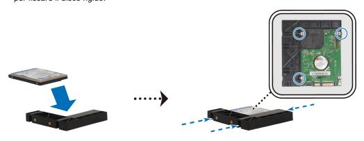
**b** Inserire il porta disco da 2,5" nell'apposito vano disco rigido e spingerlo fino a quando non si collega al connettore SATA. Fissare il supporto disco con le viti fornite.
