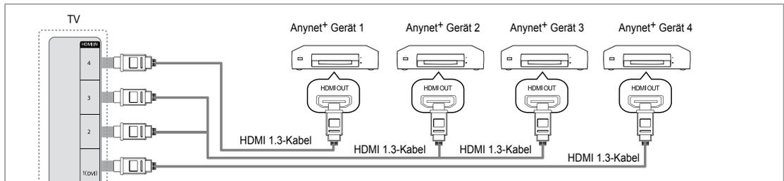
1. Verbinden Sie einen der Anschlüsse **HDMI IN (1(DVI), 2, 3 oder 4)** am Fernsehgerät mit dem **HDMI OUT**-Anschluss am entsprechenden Anynet+-Gerät. Verwenden Sie hierfür ein **HDMI-Kabel**.
