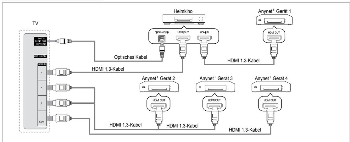
1. Verbinden Sie einen der Anschlüsse **HDMI IN (1(DVI), 2, 3 oder 4)** am Fernsehgerät mit dem **HDMI OUT**-Anschluss am entsprechenden Anynet+-Gerät. Verwenden Sie hierfür ein **HDMI-Kabel**.
