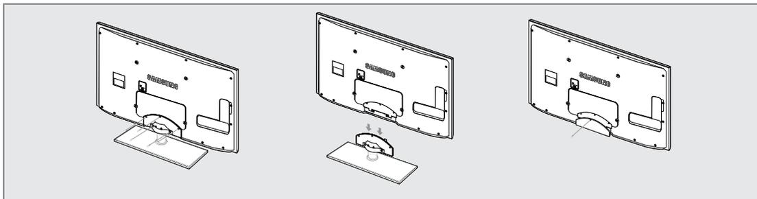
1. Entfernen Sie Schrauben von der Rückseite des Fernsehgerätes.
