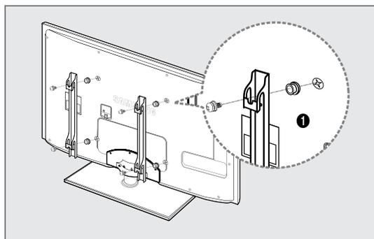
Beim Einbau einer Wandhalterung, verwenden Sie den Haltering 1.
